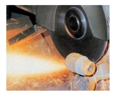
Trennschleifscheiben für ortsfeste Maschinen gewebeverstärkt für 80 m/s bzw. 100 m/s Arbeitsgeschwindigkeit
